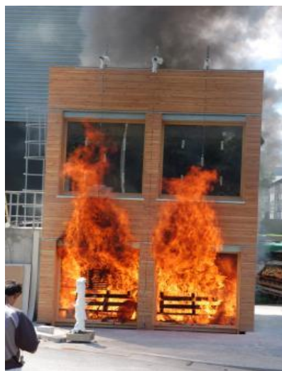
Essai au feu (CSTB 2009) pour école R+1 en ossature bois+paille, où il a été constaté que le fait d'avoir des bottes de paille en isolant protégeait l'ossature / le bâtiment plus longtemps qu'avec une isolation en laine minérale
