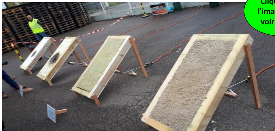
Essai comparatif (IDEM 2018), de 10 cm d'isolant sur plaque de plâtre. De gauche à droite : le PSE a brûlé au bout de 9 minutes, la laine de verre peu dense au bout de 19mn, alors qu'après 1h30, la laine de roche dense et la ouate de carton tenaient encore !
