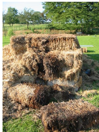
Une mauvaise protection de la paille sur plusieurs mois peut faire perdre tout ou partie du stock
