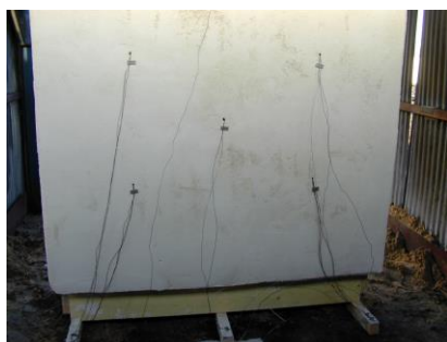
Maquette de mur équipée de sondes thermiques
