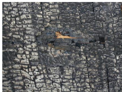
Etat du parement bois après 20 min d'essai
