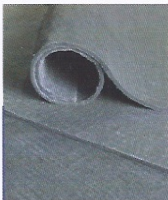
Natte d'aérogel - Dans certains cas très délicats, comme par exemple pour réduire le pont thermique que représente le tableau d'ébrasement d'une fenêtre ancienne que l'on veut conserver, les ressources de la haute technologie ne sont pas toutes à mépriser. Ces nattes incompressibles imprégnées d'un gel de silice déshydraté ont un pouvoir isolant 4 fois supérieur à celui des isolants courants ( \lambda 0,012), ce qui permet avec un panneau de fermeture (plâtre ou autre) de n'empiéter que de façon infime sur le dormant. Doc Aspen
