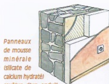
Panneaux de mousse minérale (silicate de calcium hydraté) revêtus d'un enduit terre. À condition que l'enduit intérieur initial soit capillaire et perspirant (plâtre ou chaux par exemple), et que le mortier colle de pose le soit aussi, ces panneaux ultra légers respectent parfaitement le fonctionnement hydro thermique du mur initial. Dessin : S. Hulban. Source : « L'isolation thermique écologique » éd. Terre vivante.
