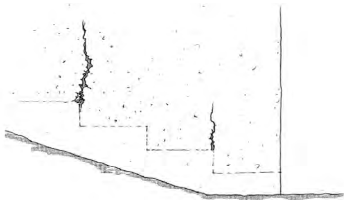
Dessin 4: Fissurations dues à un soubassement « en escalier »
