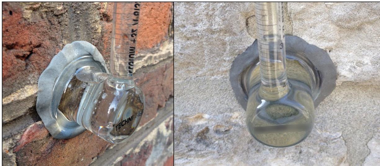
Figure 4 : A gauche : un mauvais remplissage de la pipe de verre (bulles apparentes dans la chambre et en partie supérieure de celle-ci). A droite : remplissage correct de la chambre.
