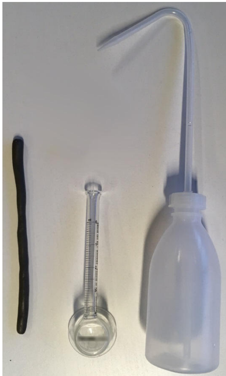
Figure 2 : Le matériel de base pour un essai de Karsten : une pipe de verre (au centre), une pissette polyéthylène (à droite) et le mastic (à gauche)
