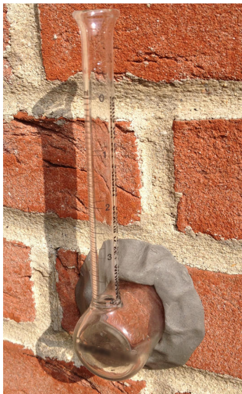
Figure 3 : Exemple d'une pipe de verre mise en œuvre. Le mastic recouvre la face en contact avec le support et est « écrasé » sur ce dernier afin de garantir un scellement étanche sur tout le contour.
