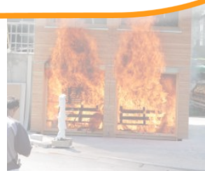
Essai au feu (CSTB 2009) pour paroi d'école en ossature bois isolés de paille
