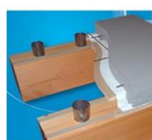
Plancher collaborant bois/béton
