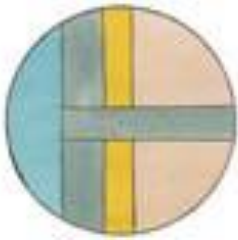
Pont thermique d'about de dalle avec ITI
