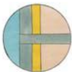
Pont thermique d'about de dalle avec ITI
